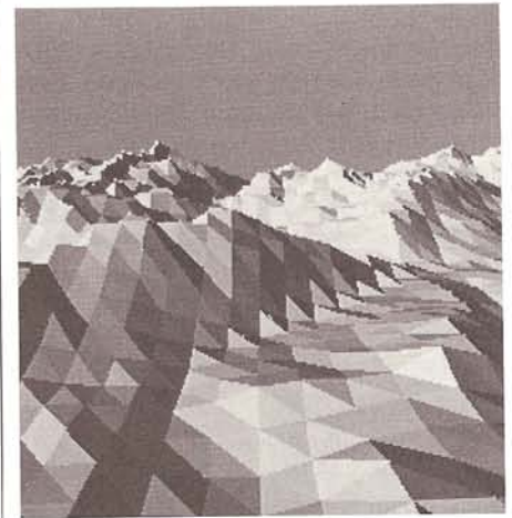
Abb. 8 Perspektivisches Schattenbild mit der Dreieckstechnik. Blick von Tour d'Ai (137/567,5/3000) nach Norden (Öffnungswinkel = 62^\circ , Bodenneigungswinkel = 20^\circ ). Beleuchtung von SW. Sichtbar sind in der Bildmitte die Pointe d'Aveneyre und hinten von links nach rechts: Rochers de Naye, Cape aux Moines, Dent de Cordon, Vanil Carré. Am Ort des heutigen Lac de l'Hongrin ist auf dem Bild noch der Talboden sichtbar.
