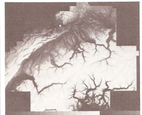
Abb. 4 Höhenbild des Geländemodells der Schweiz vor der Schattierung. Die Höhenknoten werden direkt als Bildhelligkeit wiedergegeben. Das Geländemodell besteht aus rund 1000 \times 1500 Höhenknoten im Abstand von 250 m und bedeckt eine Fläche von ca. 100\,000 \text{ km}^2 . Die unbekanntesten Höhen ausserhalb der Schweiz wurden willkürlich auf Meereshöhe gesetzt.
